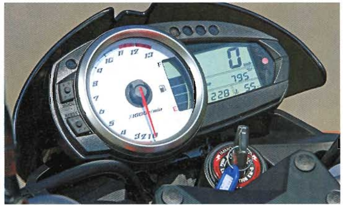
Analoger Drehzahlmesser mit integrierter Tankuhr an der Kawasaki Z 1000. Beim Cockpitdesign diente die MV Agusta Brutale als Vorbild
