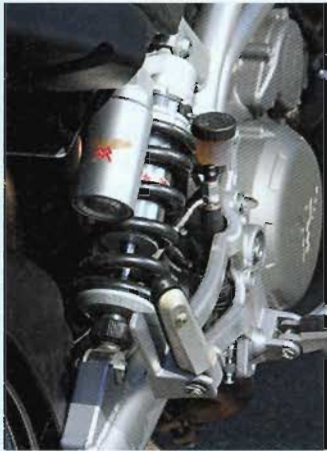
Einseitiges, voll einstellbares Paioli-Federbein an der Morini
