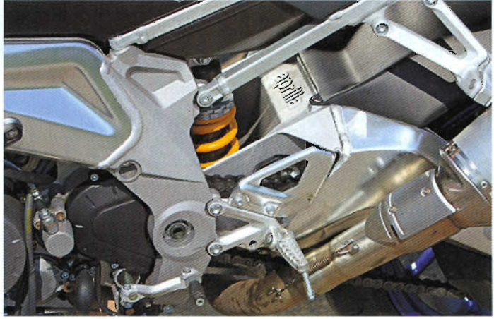
Die Tuono bietet ein komplettes Leichtmetall-Fahrwerk mit ansprechender Verarbeitung im Detail. Das Federbein gehört zur einfacheren Sorte
