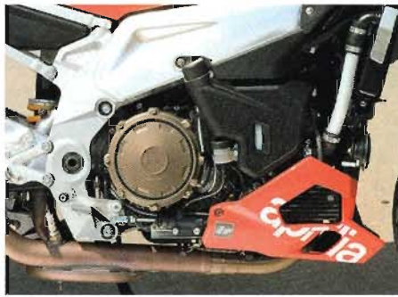
998 ccm, Zylinderwinkel 60 Grad, Werksangabe 133 PS: österreichischer Rotax-Twin für Aprilia
