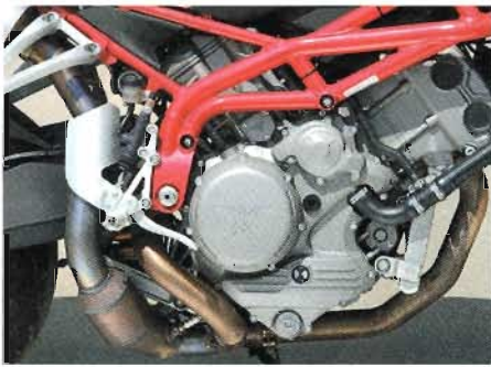
1187 ccm, Zylinderwinkel 87 Grad, Werksangabe 140 PS: neu entwickelter Motor von Moto Morini
